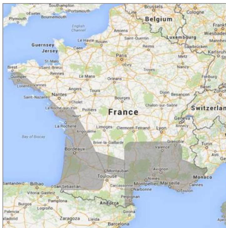
Figure 14 : Carte des zones d'émission des applications de télémesures la bande 2,3 GHz pouvant potentiellement causer des brouillages sur les réseaux mobiles
