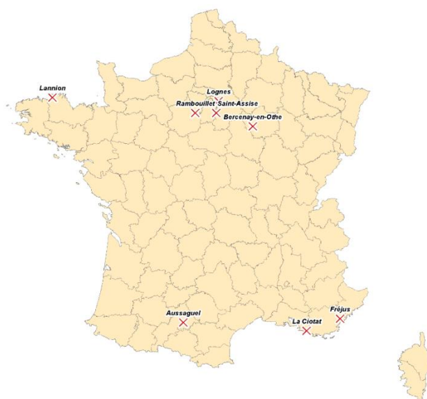
Figure 15 : Carte des stations terriennes du service fixe par satellite en bande 3,6 - 3,8 GHz
